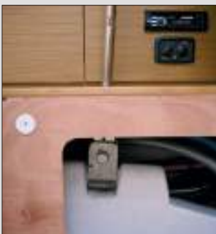
Sotto, le lande delle sartie scaricano direttamente sul controstampo strutturale tramite dei tondini in acciaio
