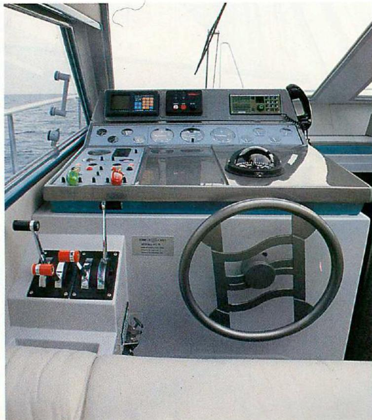
Qui a sinistra il posto guida con la bella ruota di disegno moderno e la ricca strumentazione, in cui Vhf, Loran, ecoscandaglio e bussola sono di serie. A fianco, nell'immagine più piccola, il razionale ed elegante quadro elettrico sul lato co-pilota, chiuso da un portello trasparente ed utilizzabile come piano di carteggio.
