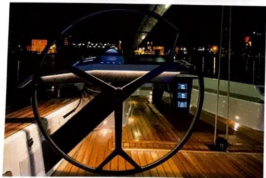
La timoneria è una delle chiavi del progetto Ice 70, da qui si comandano tutte le manovre della barca elettricamente, anche le regolazioni delle vele e l'idraulica.
