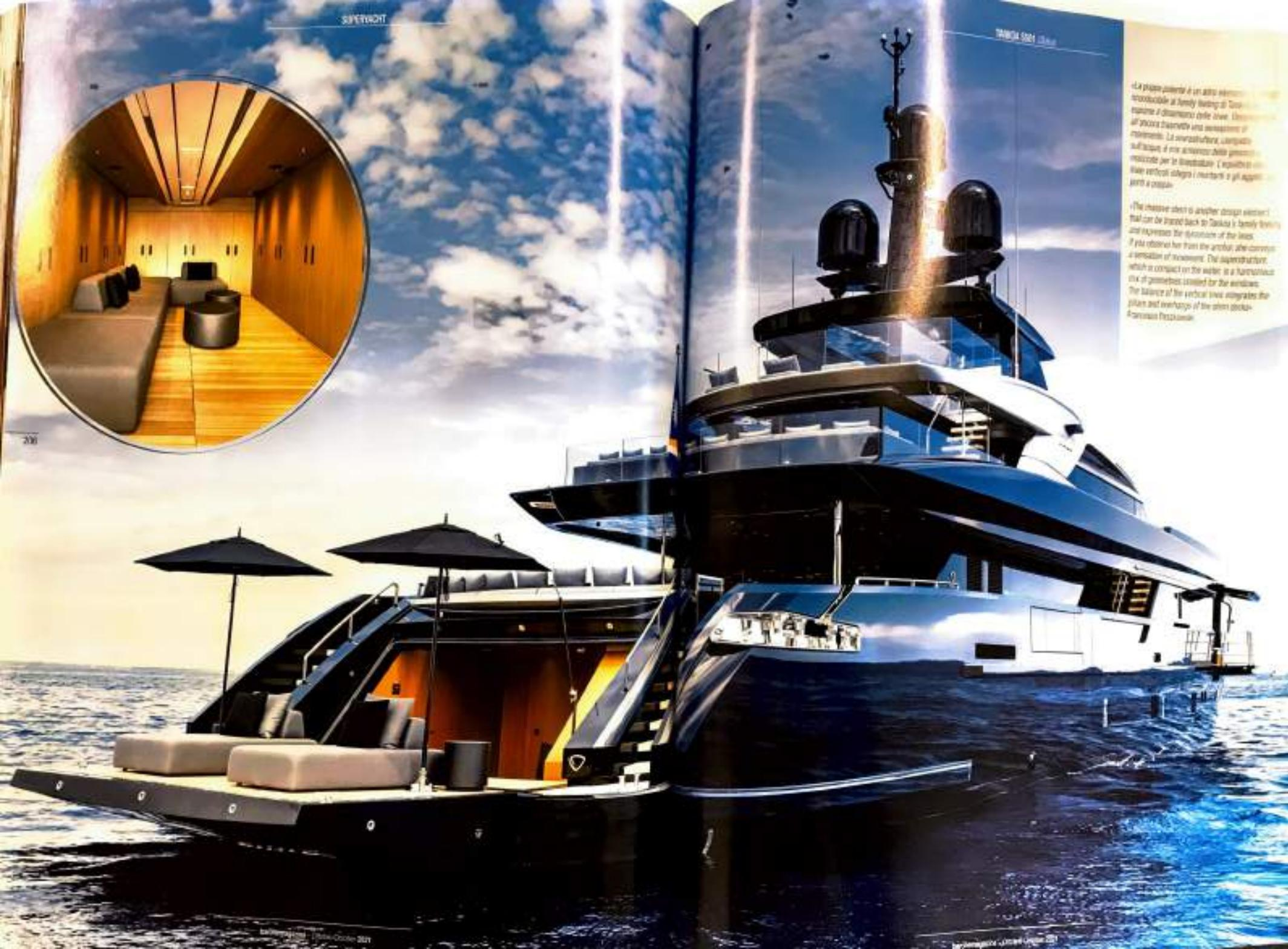
L'architettura stessa è di Francesco Rogantin, pensata per avere un'efficienza idrodinamica in grado di consentire ottime performance ai termini di velocità e consumi. Grazie a due motori Mtu 8V4000 M54 di 895 kW a 1800 rpm la nave raggiunge una velocità di 17 nodi.
