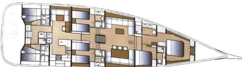
Dieci ospiti tra armatore e passeggeri e quattro posti per l'equipaggio. I volumi interni consentono di avere anche un ampio garage per il tender.
